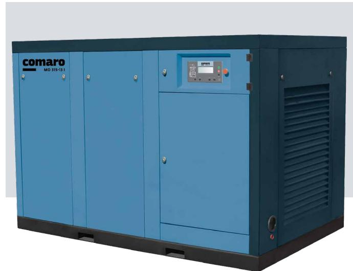
■ Для предприятий с неравномерным разбором воздуха наиболее оптимальным выбором могут стать компрессоры серии MD с частотным преобразователем (индекс «I» в названии). За счет регулировки оборотов двигателя, через прямой привод меняются и обороты винтовой пары, что позволяет компрессору производить тот объем сжатого воздуха, который будет соответствовать профилю потребления сжатого воздуха на производстве. Использование компрессоров серии MD с частотным преобразователем, позволяет:
