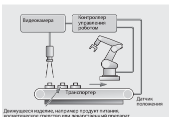
Функция синхронизации перемещения звеньев робота с перемещением захватываемого объекта
