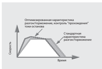
Автоматическая оптимизация характеристики разгон/торможение для сокращения периода цикла
